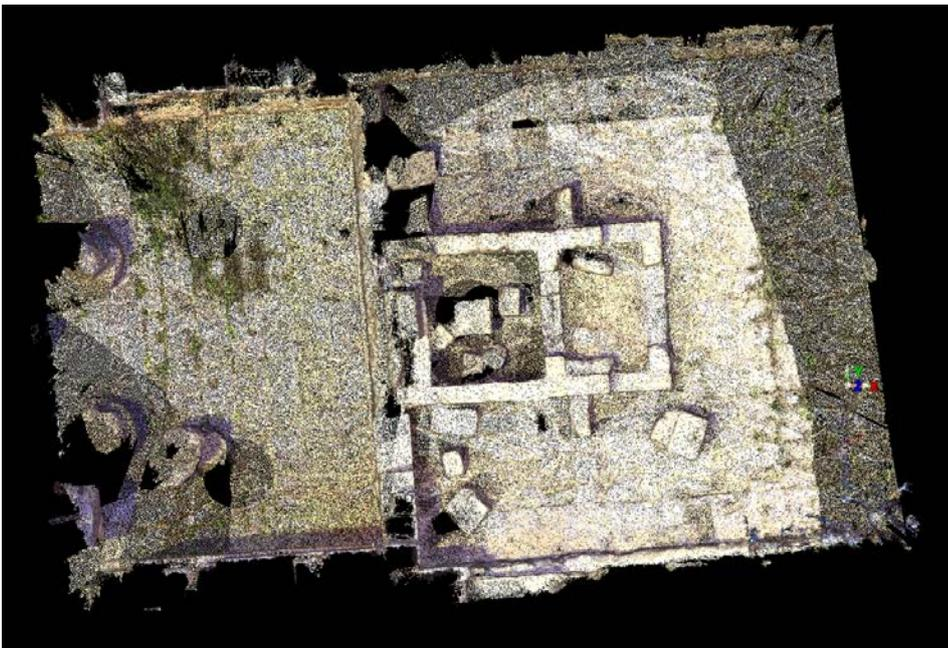
Fig. 2. Sacello del tempio A. Vista zenitale della nuvola di punti, da scansione laser (Buscemi-D'Agostino).
