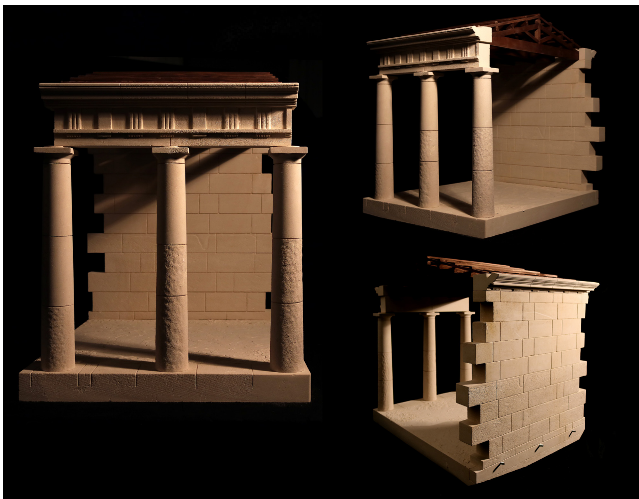
Fig. 11a,b,c. Maquette in scala 1:10 di due intercolumni del portico nord del tempio romano (modello realizzato da Pi.Mar. srl).
