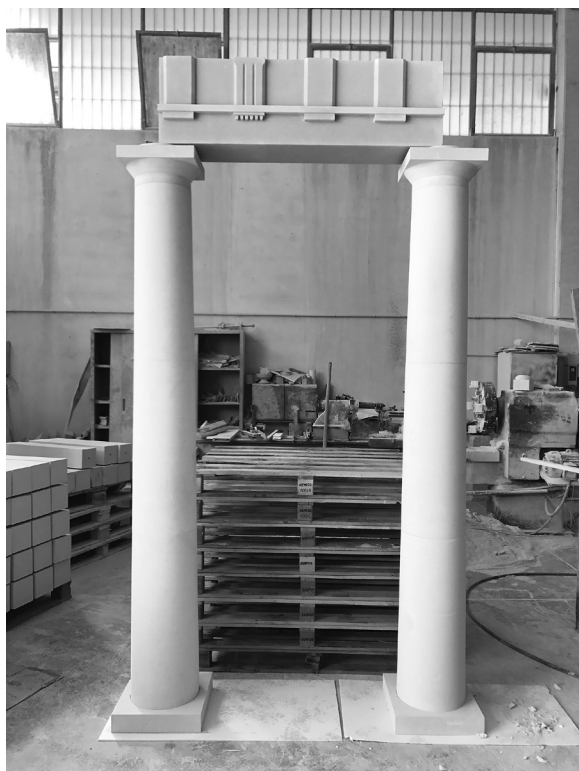
Fig. 16a,b. Agrigento, complesso del santuario romano: ricostruzione di una porzione del modello in scala reale per sottoporlo a prove di stabilità in laboratorio (realizzato da Pi.mar. srl in collaborazione con il DICAR - PoliBa).
