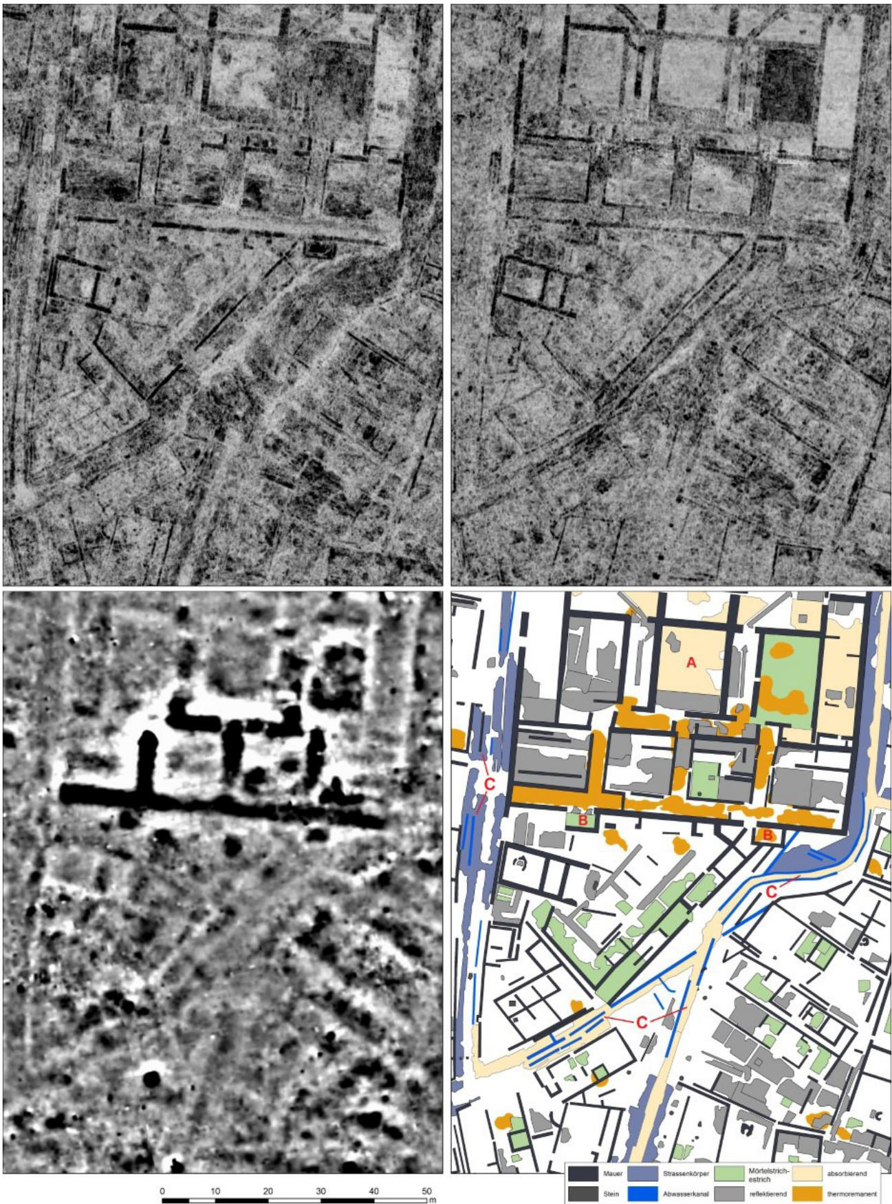
Abb. 3. Visualisierung der Bodenradardaten in einem Tiefenbereich von 50-100 cm (oben links) und des Tiefenbereiches von 100-150 cm (oben rechts). Abbildung der Geomagnetik (links unten) in einer Dynamik von  $-4$  nT bis  $+6$  nT. In der archäologischen Gesamtinterpretation (unten rechts) sind die sich zentral im Strassenkörper befindlichen Abwasserkanäle deutlich zu erkennen. A = Kurie am Forum, B = mögliche Brunnen, C = Abwasserkanäle entlang der Straßen.
